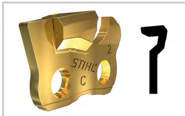
尖端經過碳化處理的鋸齒。Duro 鏈條具備超長使用壽命、便利性及良好的切割性能。髒污木材或短暫接觸到地面均不會有所影響。保持尖銳的時間是標準半鑿齒鏈條長的四倍長。尖端碳化處理鏈條無法以手工方式磨銳，必須由 STIHL 經銷商以特殊形狀的鑽石研磨滾輪加以重新磨銳。
