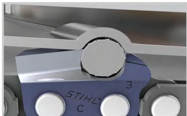
將 STIHL 銼架妥當放置在頂板及限深上，可確保將銼刀維持在正確的高度，並維持正確的側板角度。銼架上的 30° 標示亦有助您維持銼磨角度。
